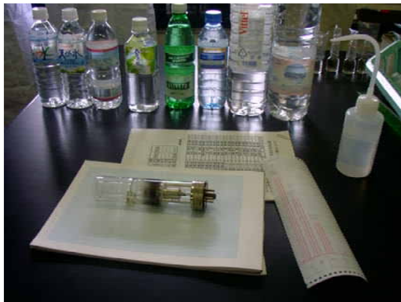
原子吸光分析で用いた中空陰極ランプと記録紙吸光信号結果
