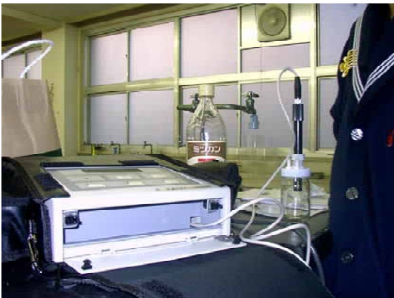
においセンサーによるガス状の酢の定量実験(物理化学部)
