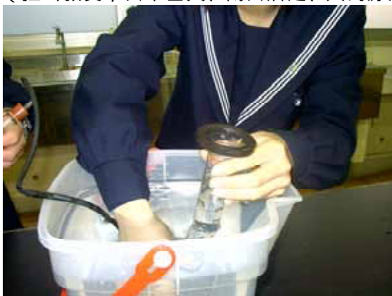
水上置換による水素の捕集
